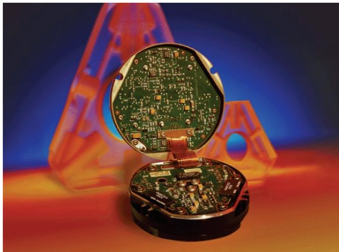
그림 1-6 링레이저 자이로스코프 (Honeywell 社 GG1320AN) [13]
