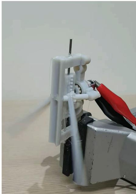
그림 2-17 제작한 센서 구동 메커니즘
