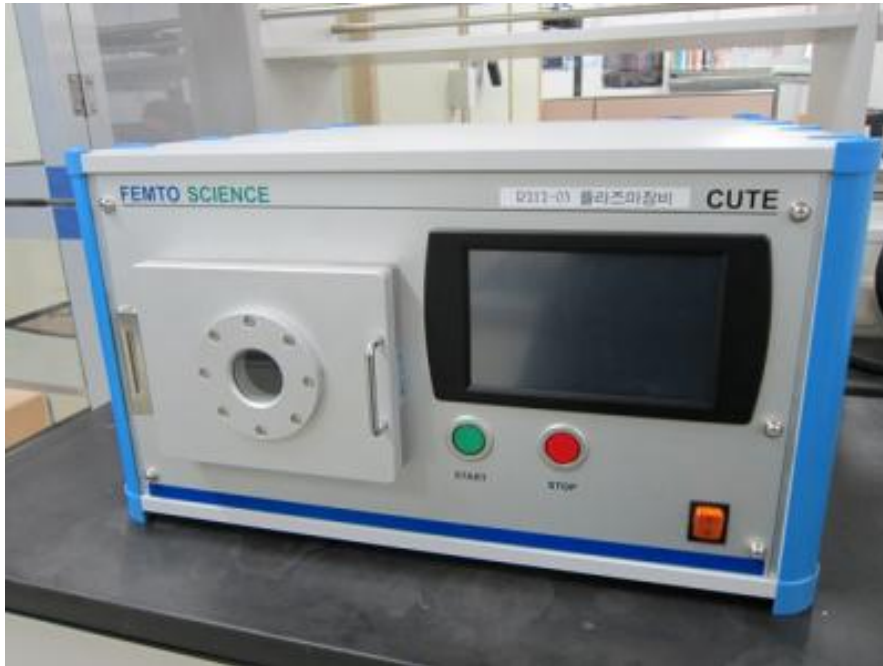
그림 7 PDMS 표면의 플라즈마 처리에 사용한 플라즈마 챔버.
