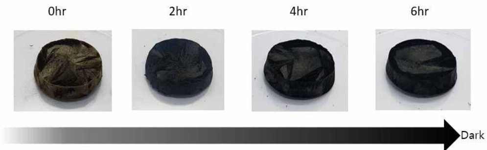
그림 26 열처리 공정 시간에 따른 CMC-rGO 에어로겔의 사진
