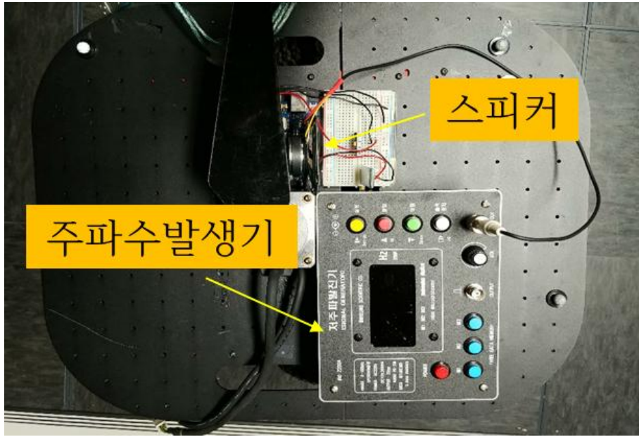
그림 28. 외부 음파 인가 실험 환경 (주파수 : 27,000 Hz)
