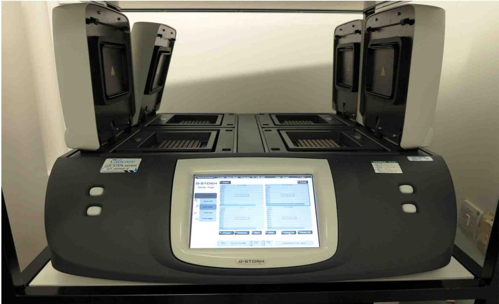
그림 1.2. 실시간 중합효소 연쇄반응 시스템이 내장된 thermal cycler[2]
