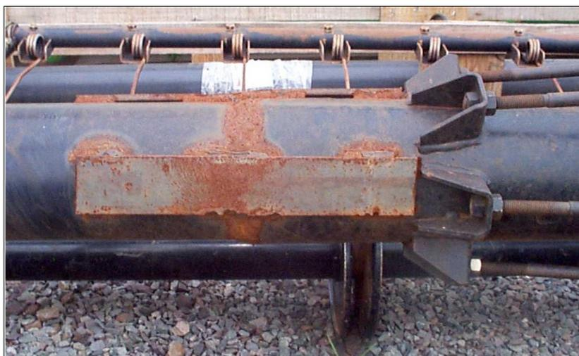
Figura 5.5 – Reparo no local de ruptura do tubo central.
