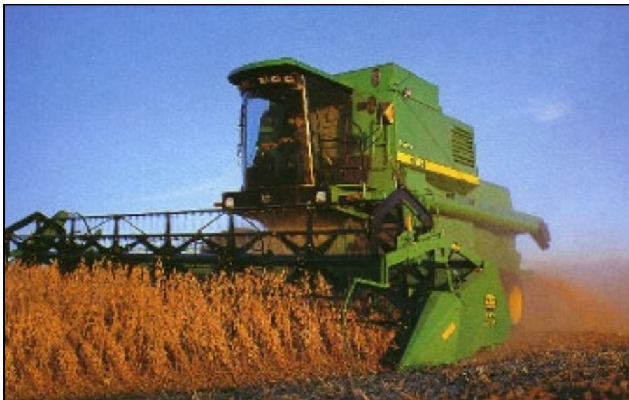
Figura 2.1 – Molinete montado na plataforma de uma colheitadeira.
