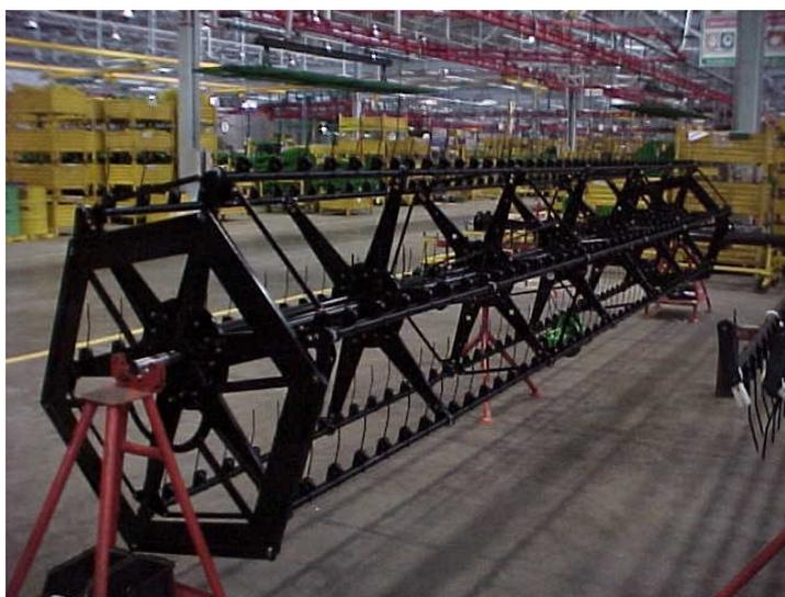
Figura 4.1 – Molinete apoiado sobre os suportes para medição do deslocamento transversal
