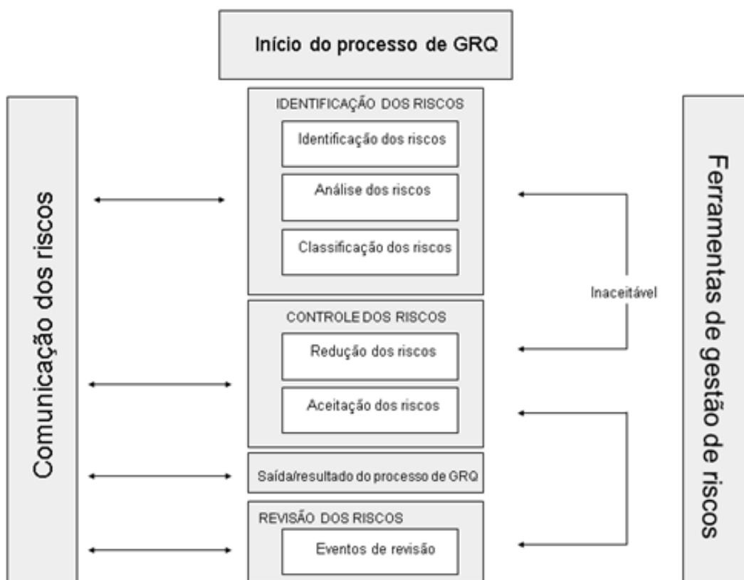
Figura 4 – Visão Geral dos Processos de Gerenciamento de Risco para Qualidade
