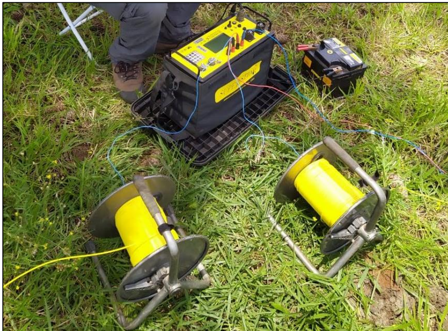
Figura 24. Resistivímetro SuperSting R1/IP, disponibilizado pela Corsan.
