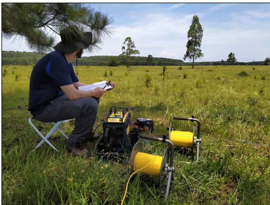
Figura 25. Anotação dos dados dos caminhamentos elétricos apresentados junto ao resistivímetro.
