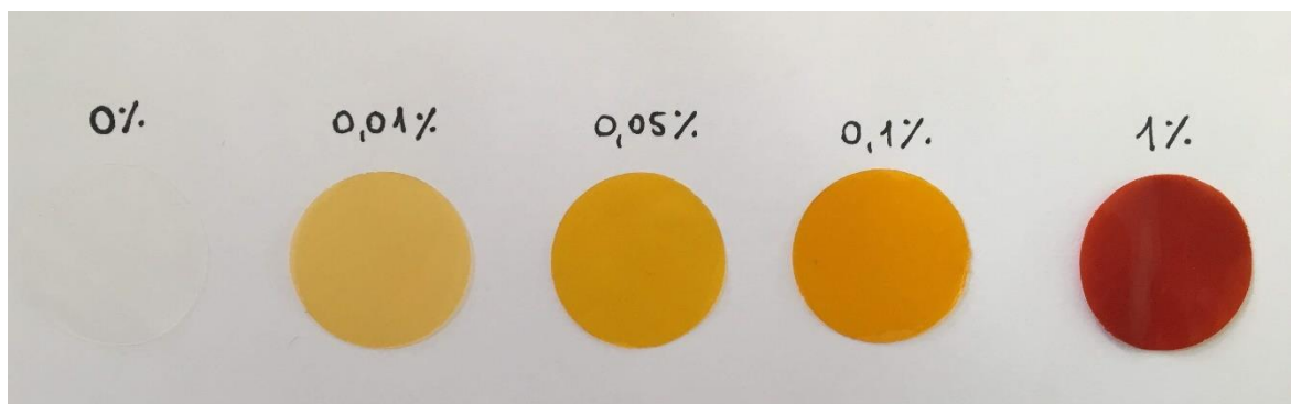
Figura 5. Filmes de PLA produzidos pela técnica de casting com diferentes concentrações de bixina
