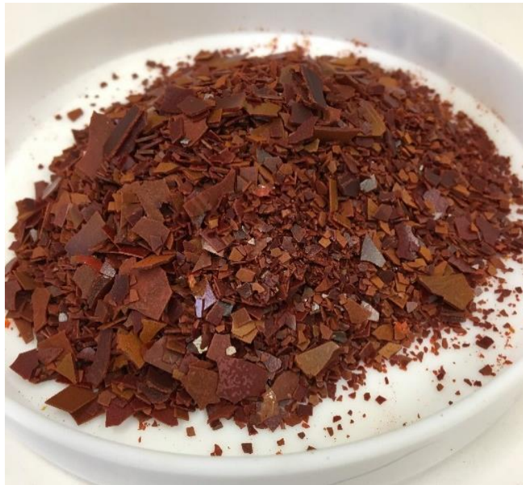
Figura 6. Master-batch de 1% bixina em PLA utilizado na produção de filmes por fusão em câmara de mistura
