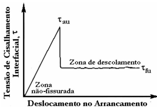
Figura 2.5: Tensões tangenciais na interface fibra-matriz (baseado em: BENTUR; MINDESS, 2007).
