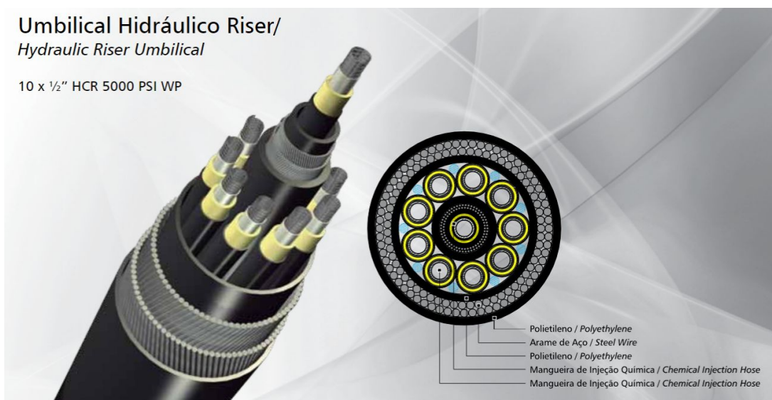
Figura 7: Umbilical hidráulico de injeção química. [19]
