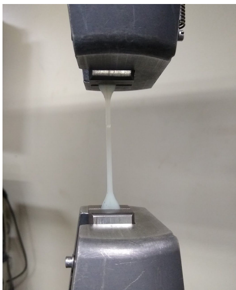
Figura 23: Ensaio de tração em andamento em corpo de prova modelo 527-5A.
