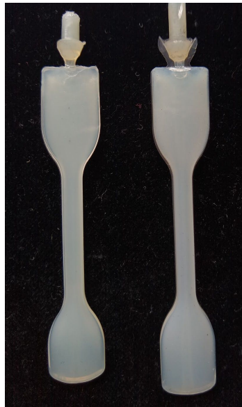
Figura 25: Resultados de injeções cujo molde não foi completamente preenchido.
