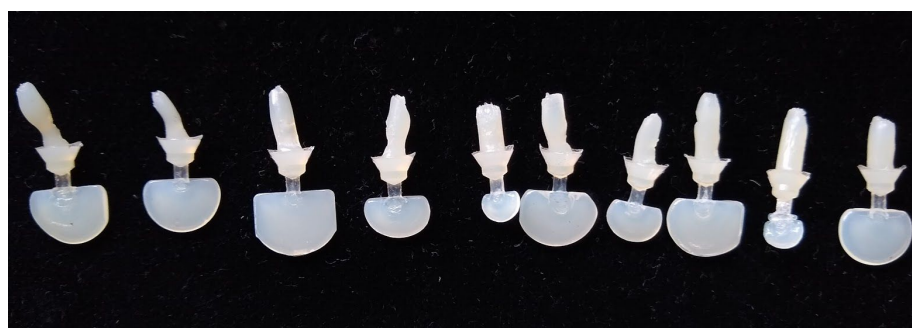
Figura 24: Resultados de injeções cujo molde não foi preenchido.
