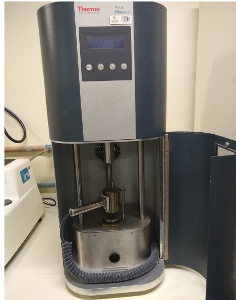
Figura 19: Injetora modelo HAAKE MiniJet II, utilizada no processamento do Nylon 11 deste trabalho.
