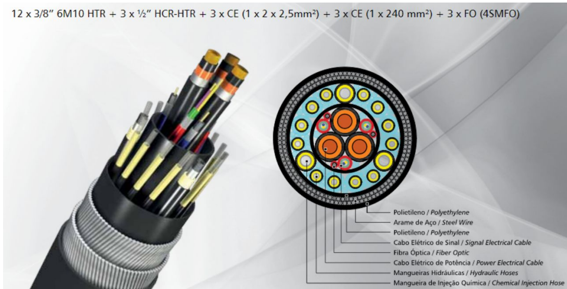
Figura 9: Umbilical híbrido com 5 funções. [19]
