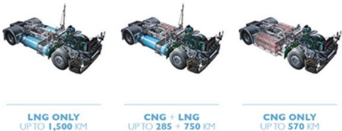
Kuva 3: Iveco Stralis NP:n kaasutekniikka vaihtoehdot [11].
