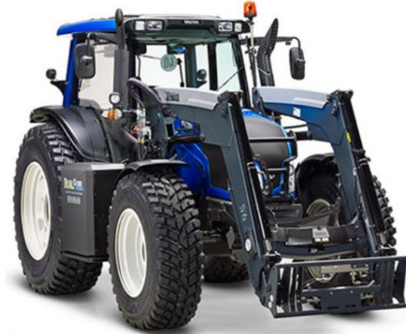
Kuva 2: Valtra N-sarjan dual-fuel kaasutraktori [4].
