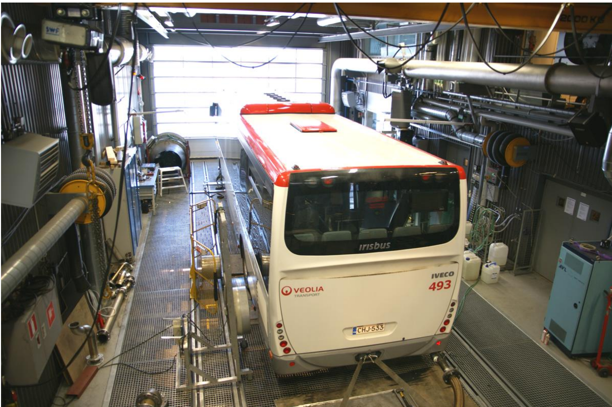
Kuva 1. Yleisnäkymä ajoneuvolaboratoriosta. Ylhäällä oikealla näkyy CVS-laitteiston laimennustunneli. Laboratorion lämpötila vakioidaan mahdollisimman tarkan toistettavuuden saavuttamiseksi.
