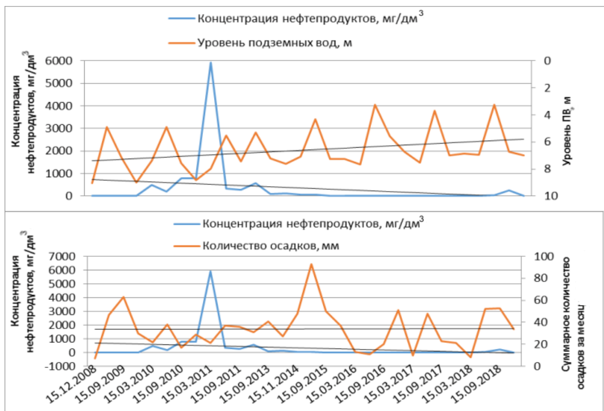
Рис. 4. Изменение концентрации нефтепродуктов в наблюдательной скважине (пойма) у реки с учетом уровня воды в скважине и количества осадков
