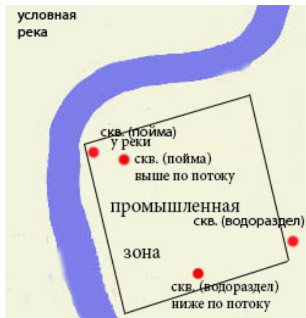
Рис. 1. Условное расположение режимных скважин промышленных зон относительно реки
