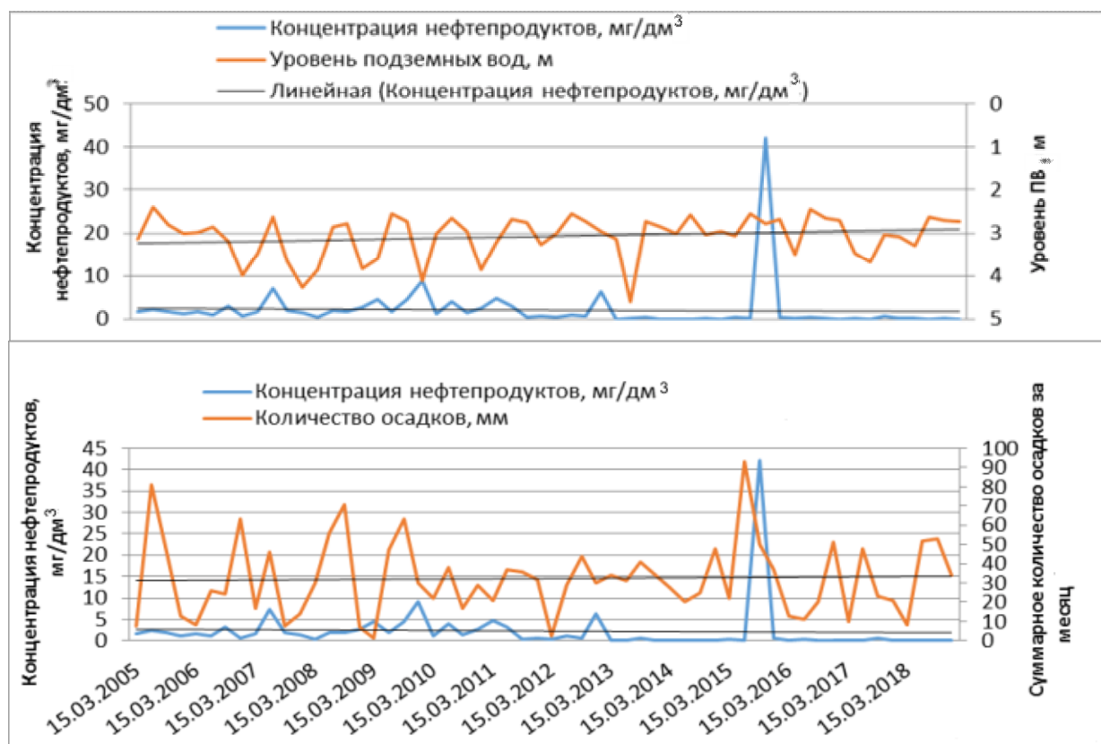
Рис. 5. Изменение концентрации нефтепродуктов в наблюдательной скважине (водораздельная равнина) с учетом уровня воды в скважине и количества осадков
