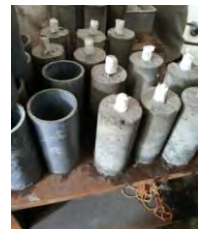
pelepasan beton dari cetakan
