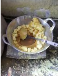
pelehan belerang sebagai pelapis permukaan uji tekan beton
