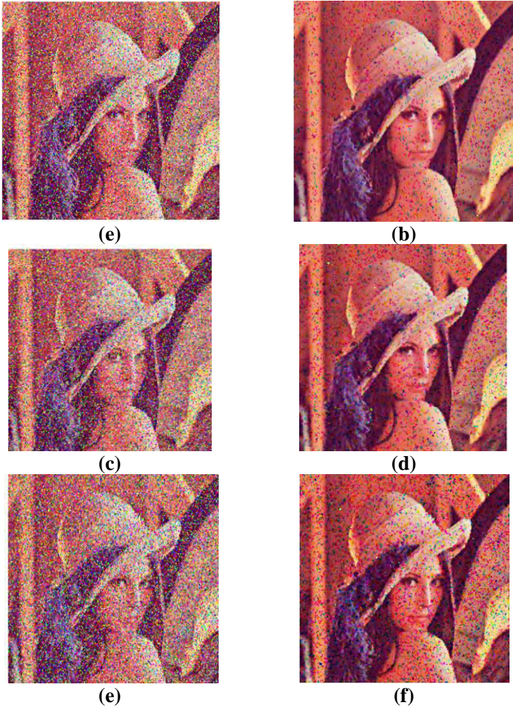
Gambar 5.2 Hasil uji coba kebenaran RML-Filter (bagian kedua) (a) Citra dengan intensitas noise 0.20 (b) Citra dengan intensitas noise 0.20 hasil RML-Filter (c) Citra dengan intensitas noise 0.25 (d) Citra dengan intensitas noise 0.25 hasil RML-Filter (e) Citra dengan intensitas noise 0.30 (f) Citra dengan intensitas noise 0.30 hasil RML-Filter
