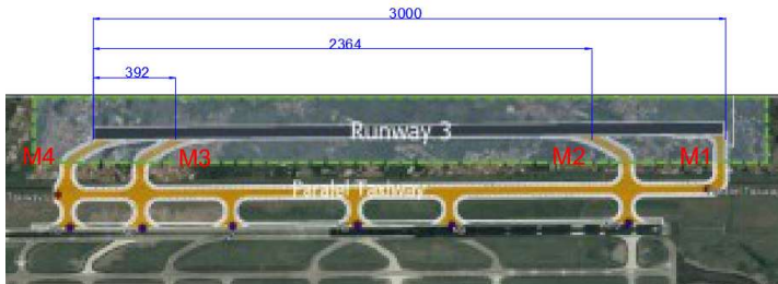
Gambar 4.3 Jarak Exit Taxiway dari Ujung Runway 06 (Sumber: Website Angkasa Pura II)
