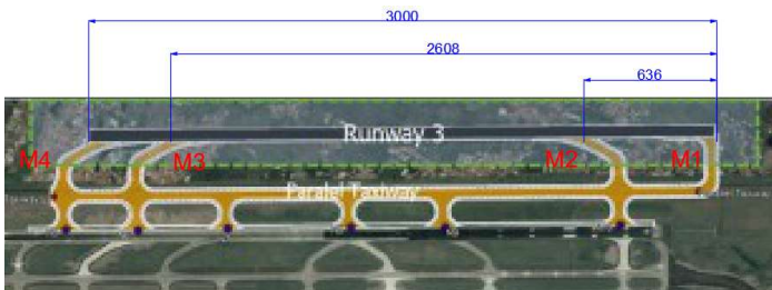
Gambar 4.4 Jarak Exit Taxiway dari Ujung Runway 24 (Sumber: Website Angkasa Pura II)
