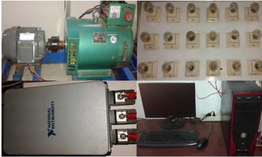
Gambar 3.9. Implementasi Sistem Deteksi Kerusakan Bearing
