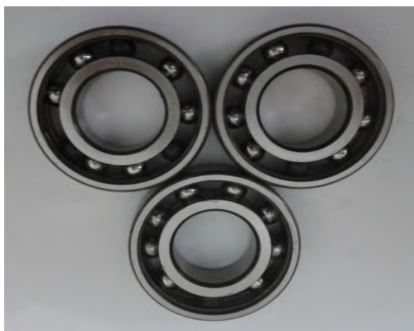
Gambar 3.1. Rekonstruksi Bearing Rusak Ball
