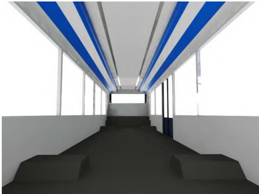
Gambar 5. 34. Assembly dengan panel interior dan vinyl lantai
