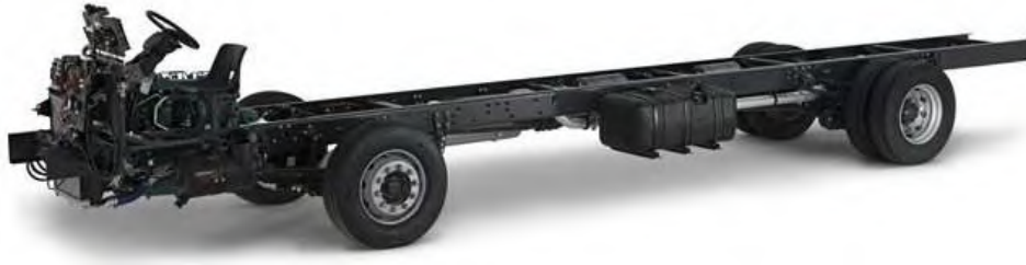
Gambar 2. 5. Chasis Ladder pada bus
