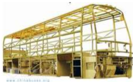
Gambar 2. 4. Chasis Monocoque pada bus
