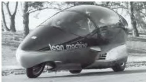
Gambar 2.2 Tilting three wheeled Lean Machine yang diciptakan General Motor [5].
