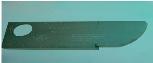
**Gambar 2.14** blok kalibrasi V1
