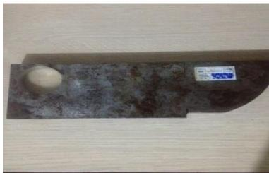
**Gambar 3.6** blok kalibrasi V1
