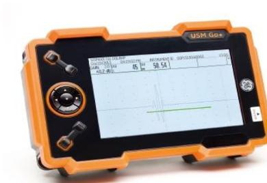
**Gambar 3.3** pesawat ultrasonik ge usm go
