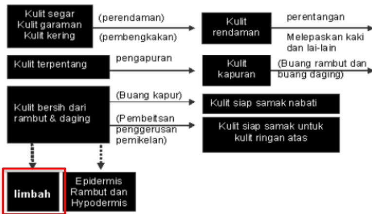
Gambar 2.4 Sketsa Tahapan Proses Mengubah Kulit Mentah Menjadi Kulit Siap Samak
