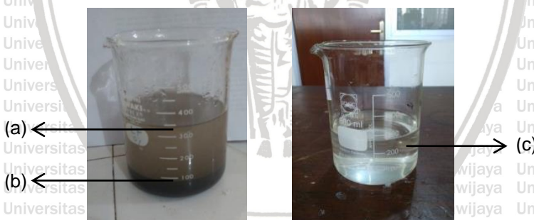
Gambar 4.1 Ekstrak Kalium silikat dari Abu Jerami Padi, (a) silikat sebelum tersaring (b) residu abu jerami (c) filtrat silikat
