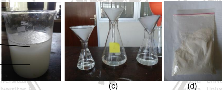
Gambar 4.2 Sintesis Silika Gel (a) larutan garam KCl, (b) hidrogel, (c) penyaringan dan pencucian hidrogel, (d) silika gel 200 mesh
