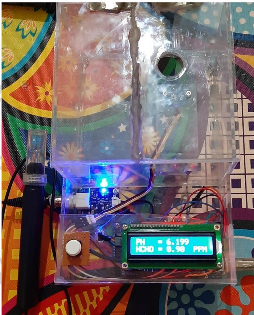
**Gambar 5.5 Implementasi Perangkat Keras Deteksi Formalin Pada Ikan Tongkol**
