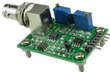
**Gambar 2.6 Modul pH Probe**
