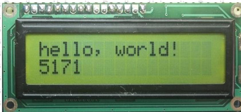
Gambar 2.4 LCD 16x2
