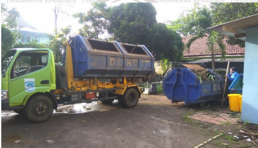
Gambar 4. 2. Kendaraan Arm Roll Truck saat Proses Penukaran Kontainer
