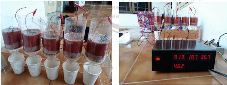
**Gambar 4.3** Wadah Proses *Electroosmosis Dewatering*
