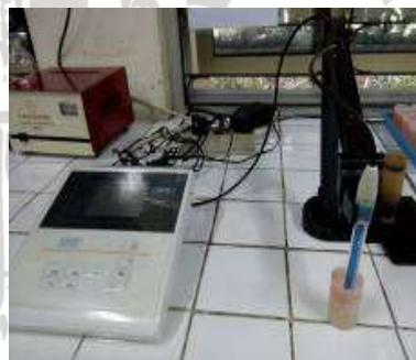
(b) Mengukur dengan pH meter
