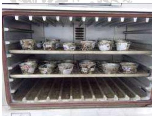
a. Tanah dimasukkan dalam cawan kemudian dioven selama 24 jam pada suhu  $110^{\circ}\text{C}$
