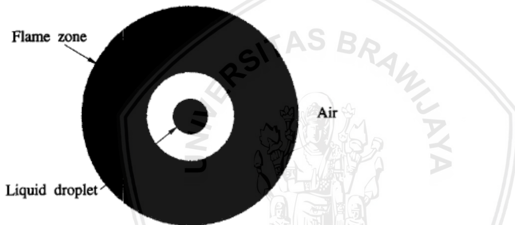
Gambar 2.11 Permodelan dari pembakaran droplet Sumber: Chang & Shieh (1994)
