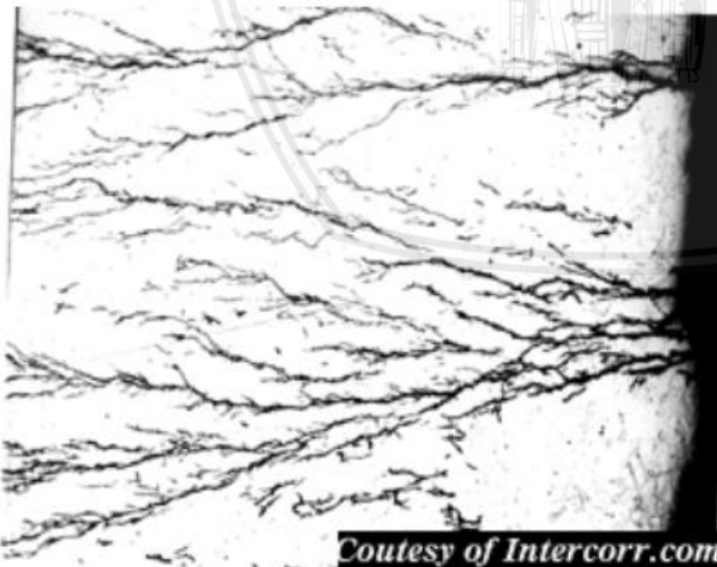
Gambar 2.4 Korosi Tegangan Sumber : Utomo (2009)
