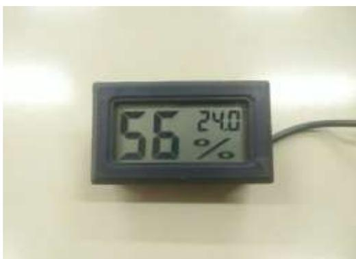
Gambar 3.10 Hygrometer dan termometer digital
