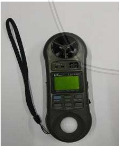
Gambar 3.12 Anemometer
