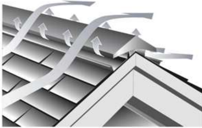
Gambar 2.8 Lubang ventilasi pada bubungan.
