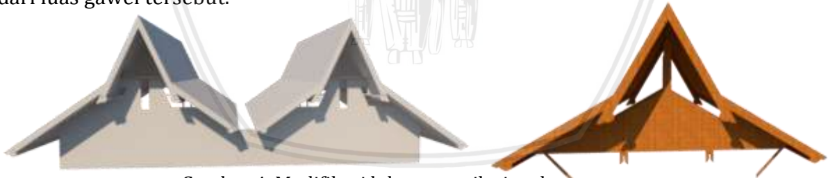
Gambar 4. Modifikasi lubang ventilasi pada ruang atap
