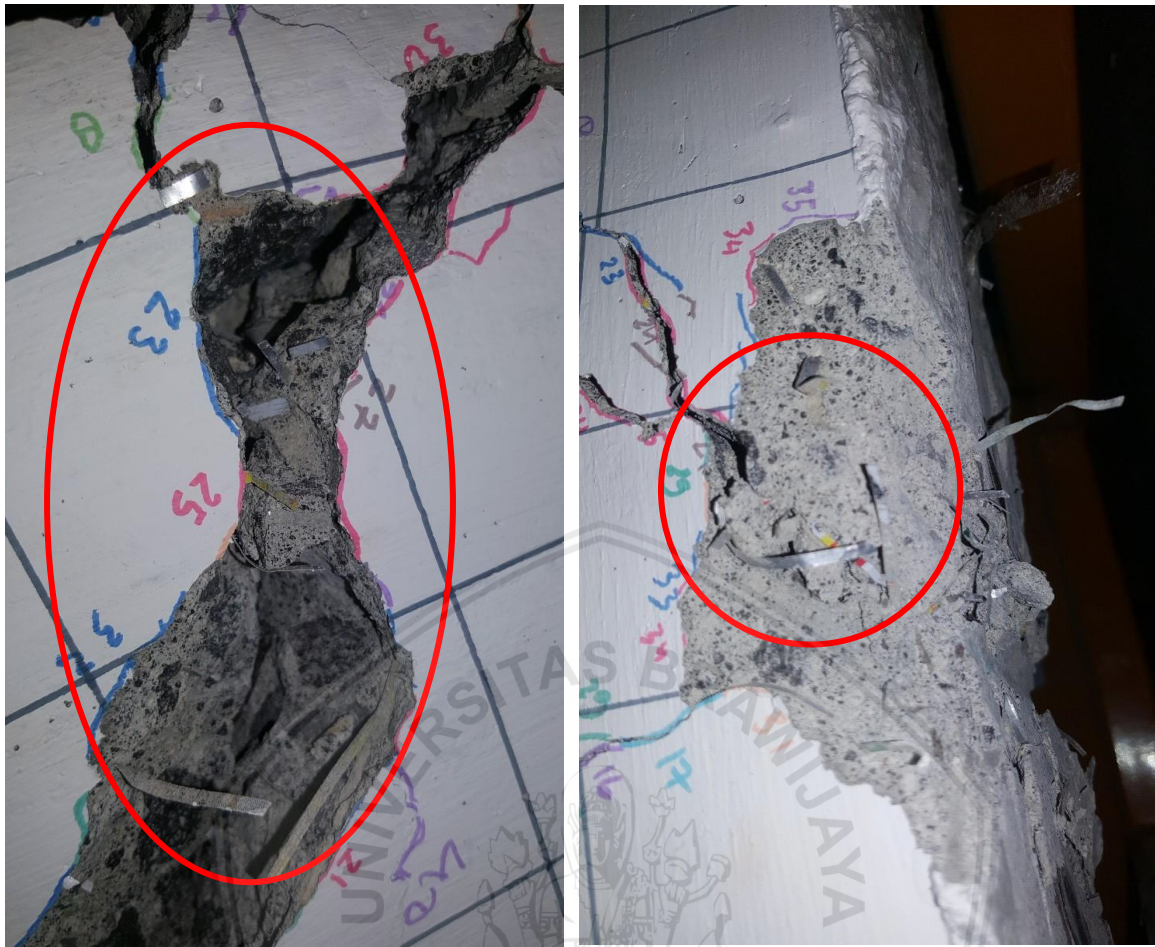
Gambar 20. Kondisi pengaruh serat 8 cm pada balok setelah dihancurkan
