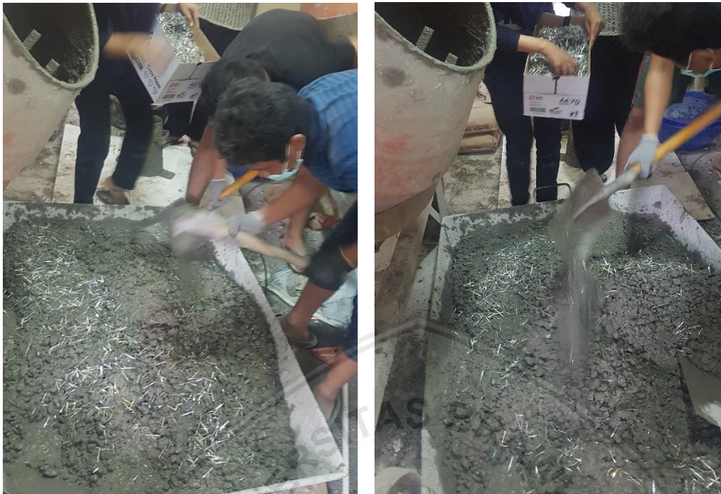
Gambar 1. Pencampuran serat kaleng ke dalam campuran beton
