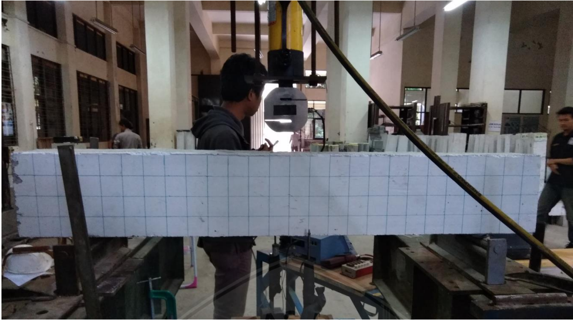
Gambar 7. Kondisi balok N2 (1) sebelum pengujian (Diuji 6 Desember 2018)
