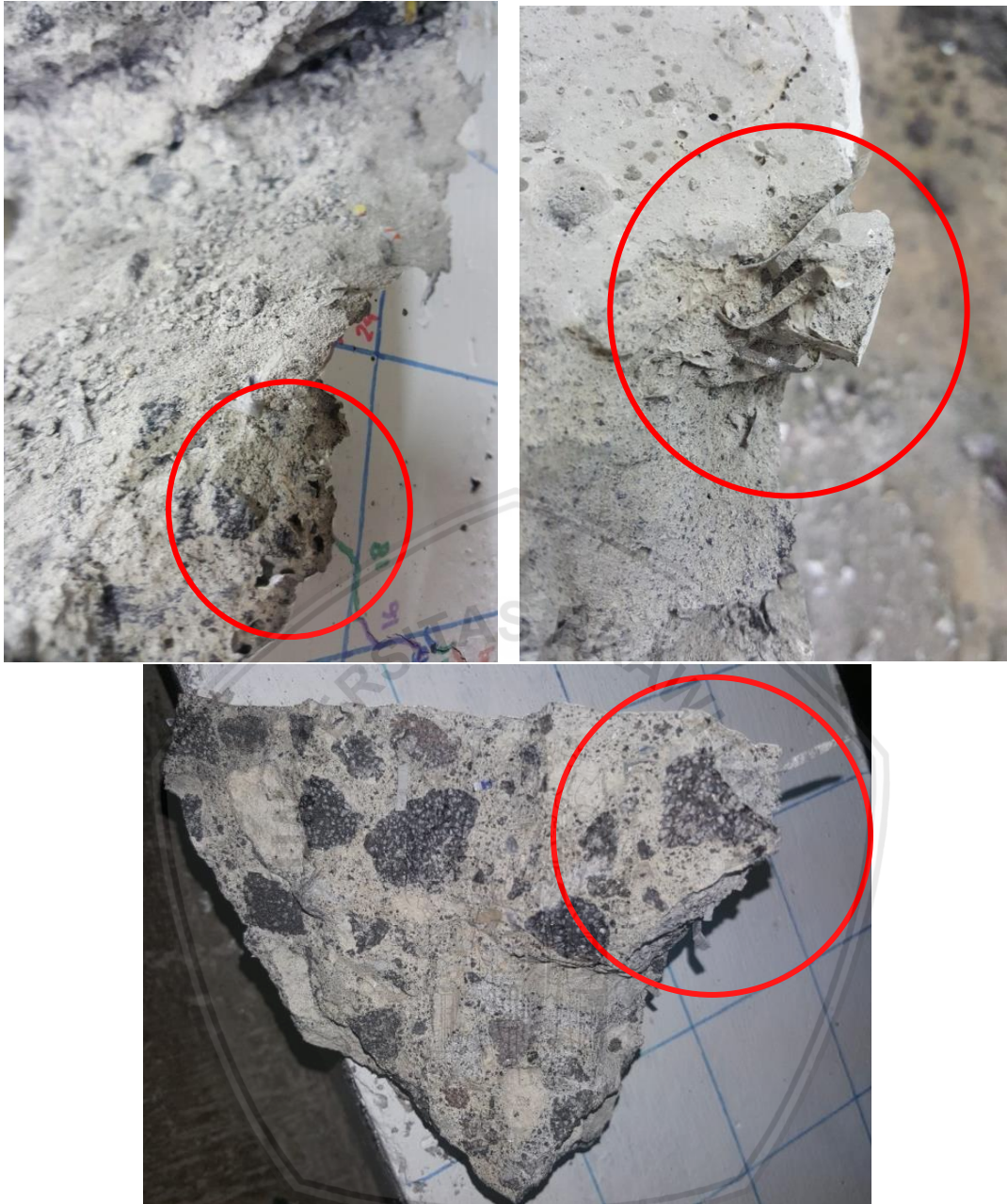
Gambar 19. Pengaruh serat 4 cm pada balok setelah dihancurkan
