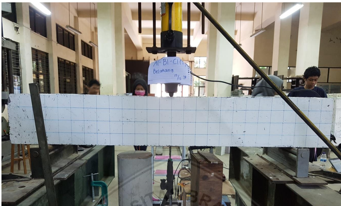
Gambar 11. Kondisi balok A1-B1-C1 (1) sebelum pengujian (Diuji 15 September 2018)
