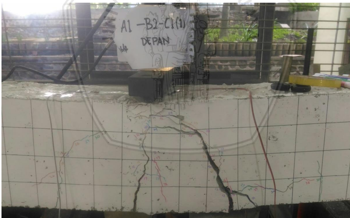
Gambar 16. Kondisi balok A1-B2-C1 (1) setelah pengujian dengan beban maksimum 4698 kg
