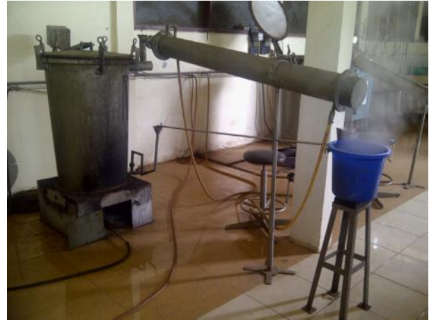
Gambar 2. Penyulingan minyak atsiri tanaman untuk mendapatkan bahan aktif pestisida nabati.
