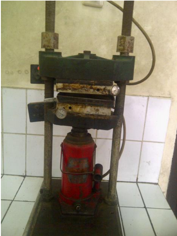
Gambar 1. Alat pengepres semiotomatis untuk mendapatkan bahan aktif pestisida nabati.
