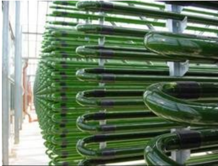
Gambar 6. Produksi mikroalga Chlorella vulgaris dan Spirulina platensis dengan bioreaktor tertutup
