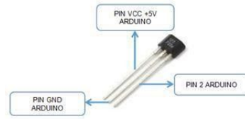
Gambar 8. Konfigurasi Sensor Efek Hall
