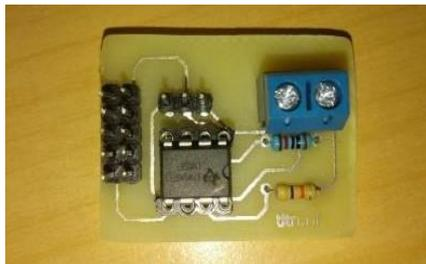
Gambar 12. Hasil rangkaian sensor frekuensi *zero crossing detector*
