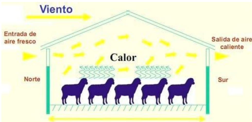
Imagen 13. Ventilación estática sin efecto chimenea
