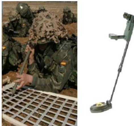
Ilustración 2: Sondeador a la izquierda y Vallon VMR3G a la derecha.
