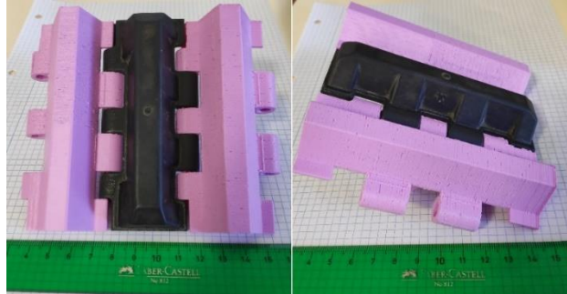
Ilustración 7: Eslabón del tren de rodaje en negro y modelos impresos en rosa.
