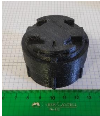
Ilustración 13: Réplica de la mina M14 impresa en ABS.
