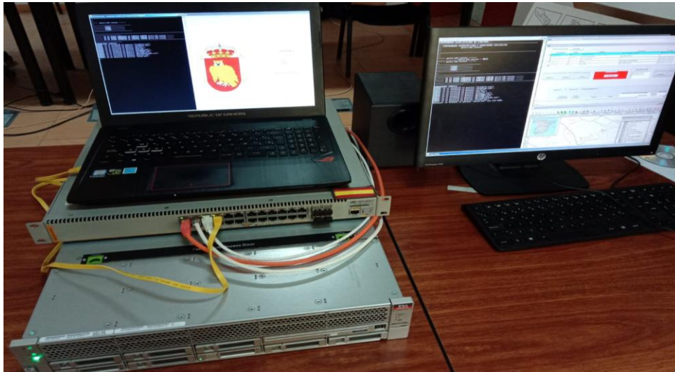
Figura 4.2.2-7: Prueba de conectividad entre VM y servidor de datos GESTA con dos equipos distintos
