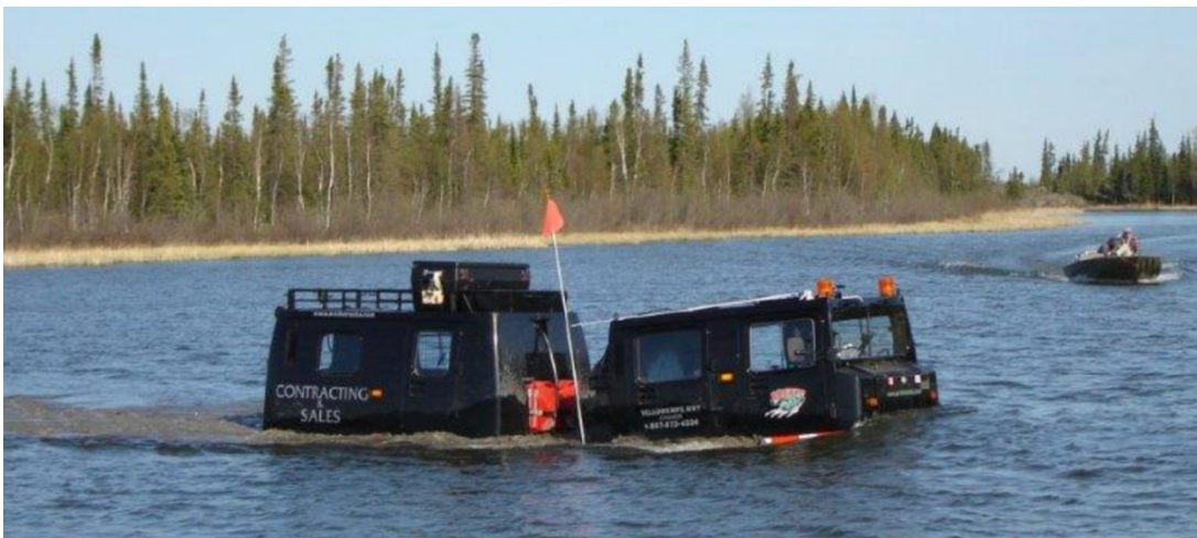
Figura 2. Vehículo Bv 206 vadeando un río. Fuente: Arctic Trucks.
