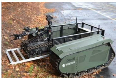
Ilustración 5-2. Modelo TITAN transportando un UGV de clase I de desactivación. [13]
