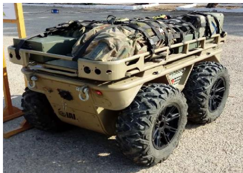
Ilustración 5-4. Modelo REX LR-1 transportando material colectivo [4]
