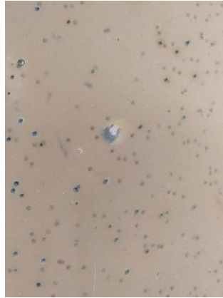
Ilustración 15: Orificios tras el impacto de distintos calibres. Fuente: elaboración propia.
