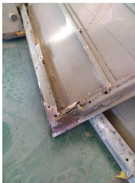
Ilustración 59: Ejemplo de una puerta de VAMTAC en la que comienzan a aparecer signos de oxidación. Elaboración propia.
