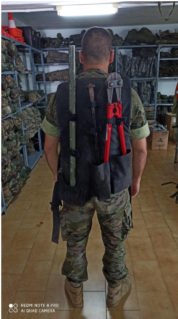
Ilustración 33: Ejemplo de mochila portaherramientas dotada con una palanca, una halligan tool y una cizalla.
