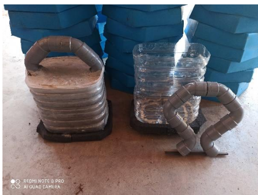
Ilustración 2: Modelo hecho a partir de garrafas de agua de 6 litros y tubos de PVC.
