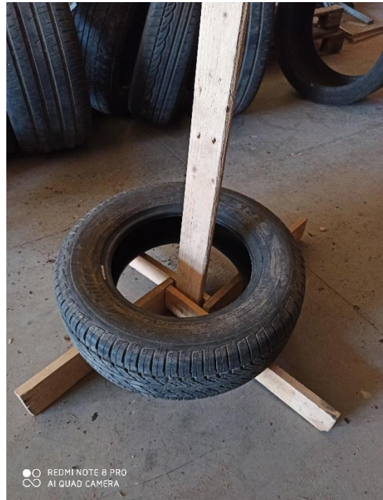
Ilustración 7: Neumático utilizado como contrapeso.
