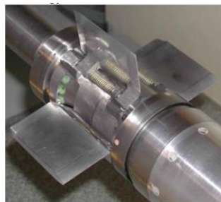
Ilustración 10. Aletas de control del misil Mistral 3.
