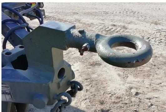
Figura 2.2 Adaptación de la altura del argollón de los remolques
