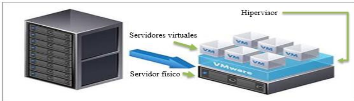
Ilustración 9 Esquema del proceso de Virtualización [22]
