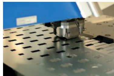
Ilustración 89: Imagen de una proceso de troquelado.
