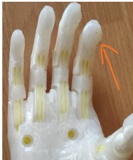
Ilustración 18. Recubrimiento con Silicona
