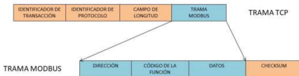
Figura 12: estructura de las tramas TCP y Modbus.
