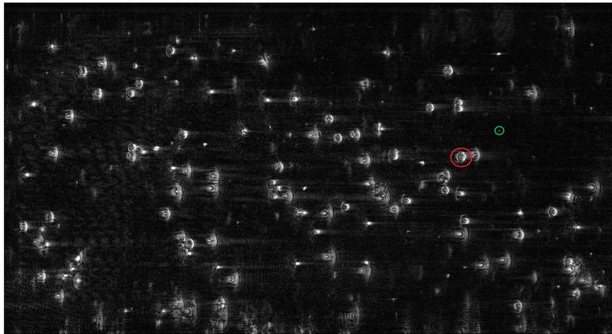
**Figura 1:** Proyección en  $Z=0$  (centro del canal) del holograma. En rojo, un ejemplo de partícula blanca, y en verde, uno de magnética. Se puede apreciar también la presencia de ruido.
