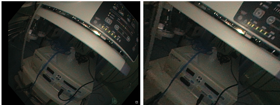
Figura 5.3: Imágenes del endoscopio: distorsionada (izq) y tras corregir la distorsión (dcha)
