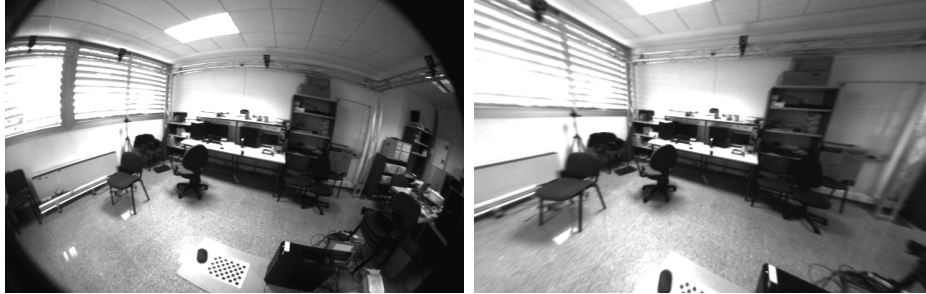
Figura 5.1: Imágenes del laboratorio: distorsionada (izq) y tras corregir la distorsión (dcha)
